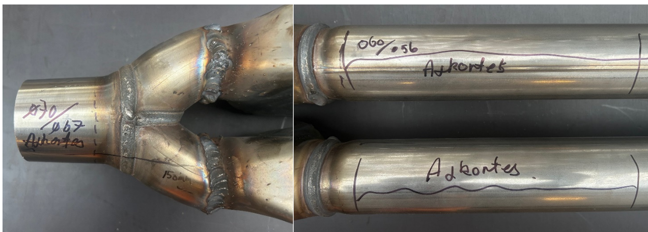
Indgangsstuds og afgangsrør. Tilpasses i længden.
